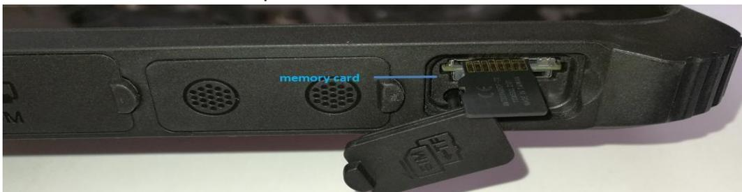
in den TF-Kartensteckplatz ein, wie in der Abbildung gezeigt (der SIM-Kartensteckplatz befindet sich über dem TF-Kartensteckplatz). Note: The metal side of the TF card faces the display.
