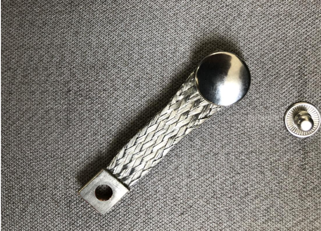
Bild 3: Verwendung von Druckknöpfen zur Herstellung des elektrischen Kontakts mit der Grundplatte
