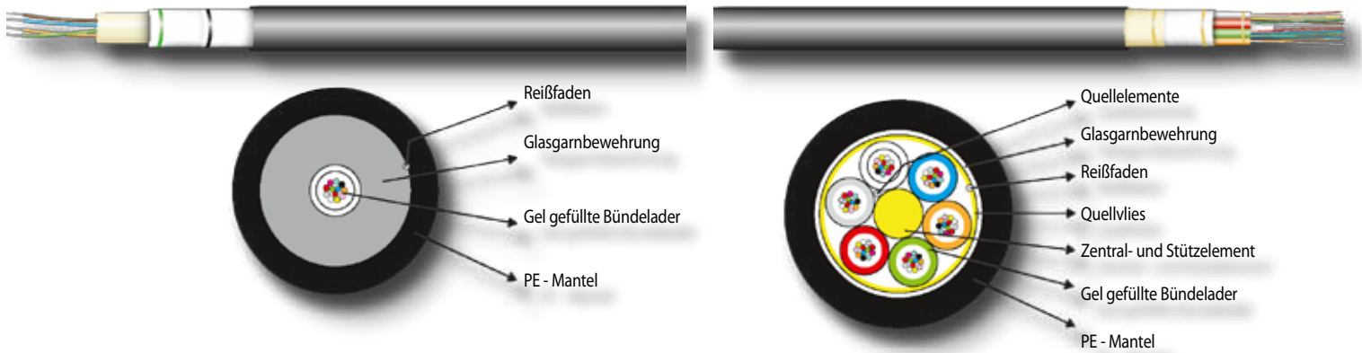
mit zentraler Bündelader bis 24 Fasern
