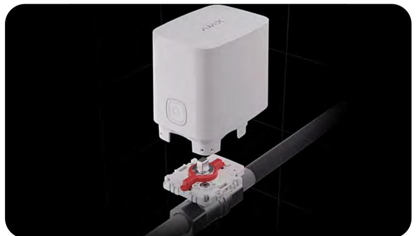
Die Wasserversorgung kann nicht nur über Apps und Szenarien, sondern auch manuell gesteuert werden. Dazu gibt es eine Taste am Gehäuse von WaterStop sowie einen Hebel auf der Montageplatte des Absperrventils. Das ist zum Beispiel praktisch, wenn der Elektroantrieb ausgetauscht wird oder ein Klempner arbeitet.
