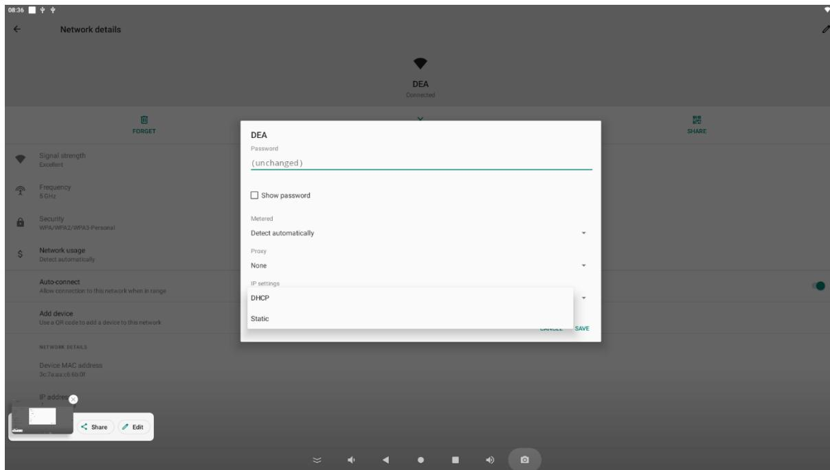
Eine statische Netzwerkverbindung können Sie unter IP Setting einrichten. Durch den Klick auf „static“ können Sie die IP-Adresse, Gateway und DNS Server einrichten.
