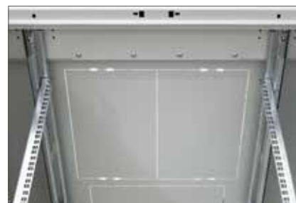
■ Öffnung für die Belüftungseinheit Die große, mit einer herausbrechbaren Verblendung versehene Öffnung ermöglicht die Montage eines Lüfterbleches. Eine entsprechende Belüftungseinheit gemäß Schrankgrundriss ist auf Seite 9 und 11.
