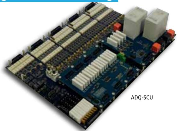
Die Signalkonditionierungseinheit ADQ-SCU wurde entwickelt, um eine Vielzahl analoger und digitaler Ein-/Ausgänge an die Anforderungen eines komplexen, automatisierten Testsystems optimal anzupassen. Die Erfassung und Generierung der Signale erfolgt synchron über die multifunktionale Mess- und Steuerkarte ADQ-344, welche gleichzeitig die Ansteuerung der ADQ-SCU via I<sup>2</sup>C-Bus übernimmt.
