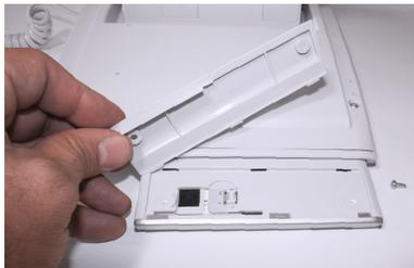
Mit abgenommenen Displaydeckel wird die Schnittstelle für den Plug & Play EHS Adapter Connector sichtbar.
