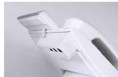
Der fertig montierte Plug & Play EHS Adapter fügt sich optisch gut an das Systemtelefon und initialisiert sich selbstständig zur Nutzung. Nun gilt es nur noch das jeweils gewünschte schnurlos-Headset anzuschließen. Dazu bitte ausschließlich original tss smartTec Anschlusskabel verwenden.
