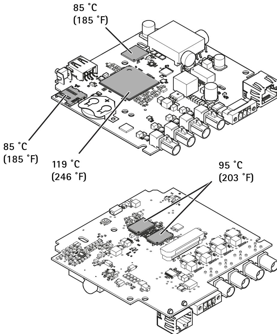
1 Maximal zulässige Temperaturen. Wenn die Umgebungstemperatur 35 °C (95 °F) oder höher beträgt, steigt die Temperatur der Komponenten und sie müssen gekühlt werden.
