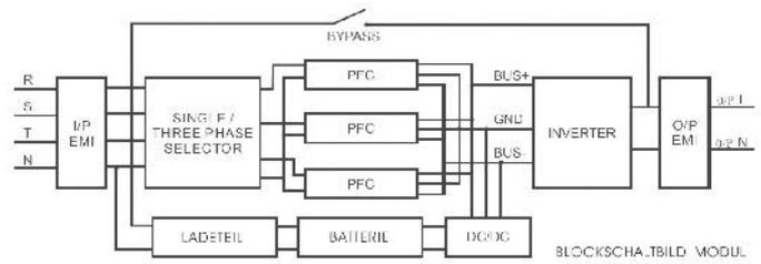
Die MHD Modular liefert durch schnelle DSP-Berechnung (Digital Signal Processing) nahezu perfekte Sinusqualität zur Versorgung von kritischen Verbrauchern.
