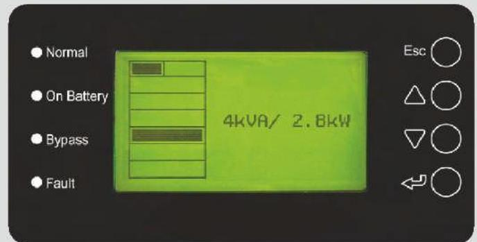
Es können alle Werte, wie Ein- und Ausgangsspannung, Frequenz, Anschlusswerte, Position und Zustand der einzelnen Module angezeigt werden. Unterstützt wird diese Übersichtlichkeit durch zusätzliche LEDs für die Meldung der wichtigsten Zustandsinformationen auf einen Blick, wie Betriebsmodus „Normal“, „On Battery“, „Bypass“ und „Störung“.
