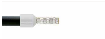
Aderendhülse, aus Kupfer, mit verzinnter Oberfläche (gasdicht aufgecrimpt)
