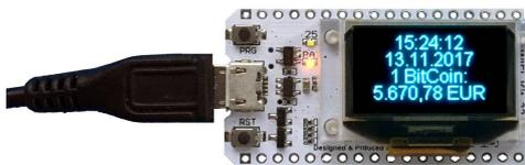
El Display solo requiere un puerto USB para la alimentación y acceso a un punto de acceso Wi-Fi que permite que la pantalla se conecte a Internet. La conexión de la pantalla a un punto de acceso público se realiza a través de un Smartphone, con el que se selecciona el Display-IoT de ALLNET.
