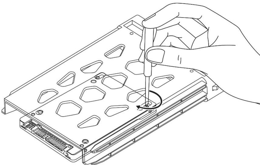
Schritt 3 : Installieren und ziehen Sie die Schrauben von hinten fest wie gezeigt, und installieren Sie die Halterung wieder in dem Gehäuse.
