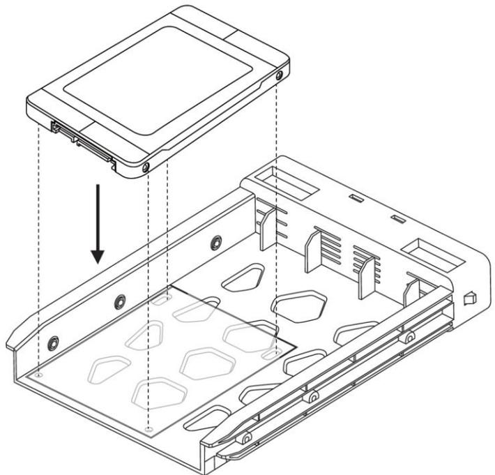
Schritt 2 : Richten Sie die Festplatte wie in der Abbildung gezeigt an den vier festen Löchern an der Halterung aus, drehen Sie sie dann um und legen Sie sie auf den Tisch.
