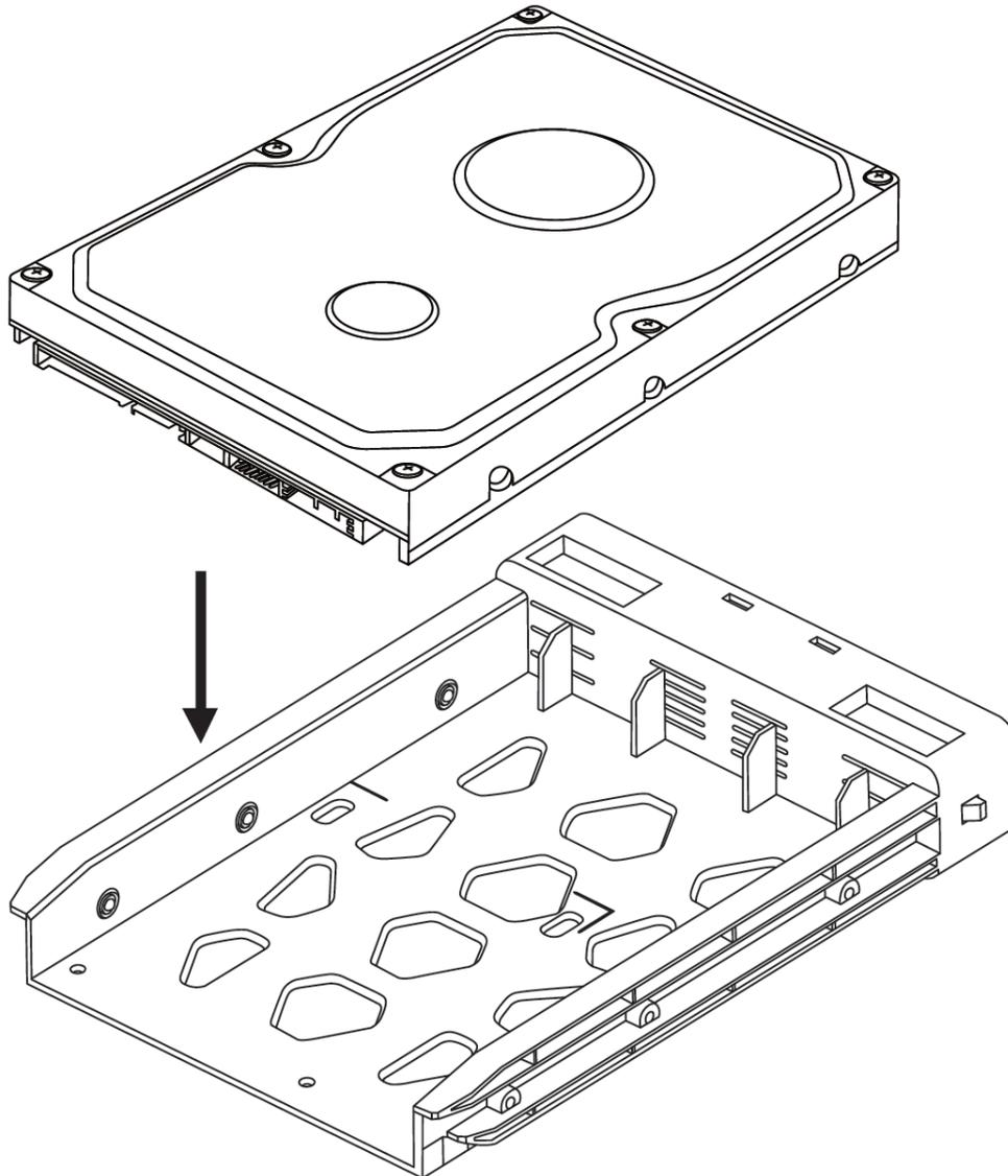
Schritt 2 : Richten Sie die sechs Stahlkugeln an der Halterung wie in der Abbildung gezeigt mit den Schraubenlöchern an der Festplatte aus und setzen Sie die Festplatte Festplattenhalterung von oben nach unten ein.
